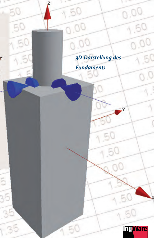
Eingespanntes Fundament mit Erddrücken
